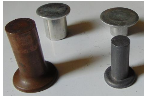
Рис. 3. Деталі, які виготовлені поперечним видавлюванням
