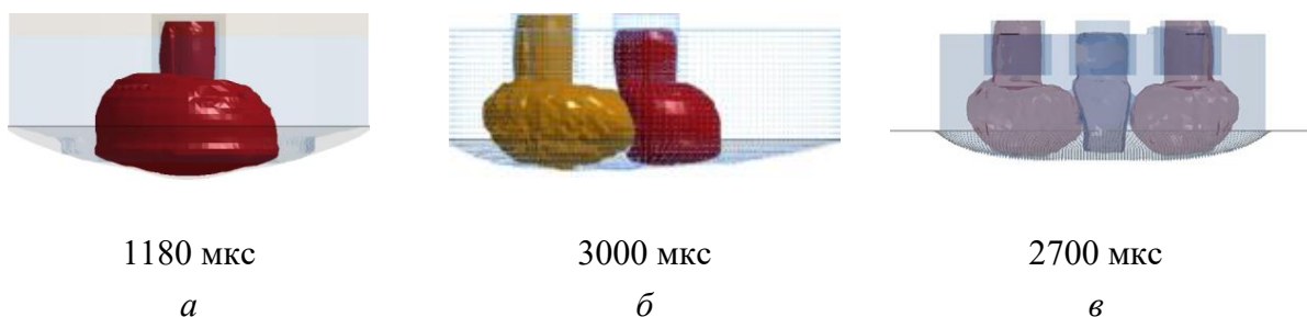
Рис. 8. Взаємодія затоплених струменів рідини, що генеруються ЕГ-розрядом, із заготовкою при виділенні енергії в одній ( a ), двох ( б ) і трьох ( в ) розрядних порожнинах: вказаний час закінчення інтенсивної формозміни заготовки
