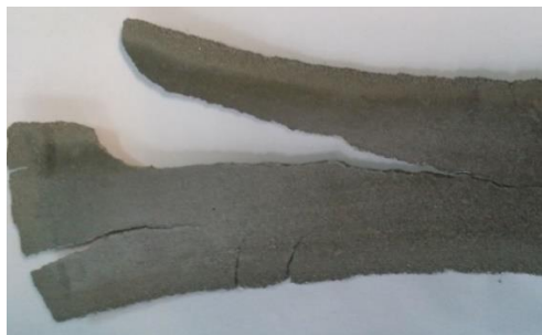
Рис. 5. Руїнування порошкового прокату при використанні схеми симетричної прокатки
