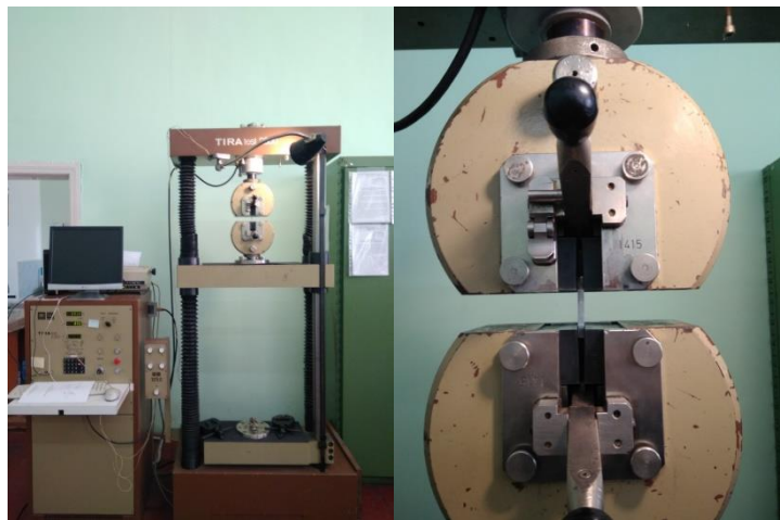
Рис. 2. Універсальна випробувальна машина TIRA TEST-2300.
