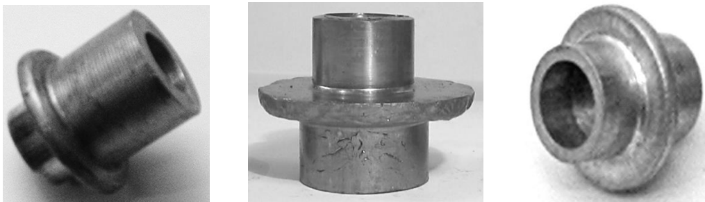
Рис. 10. Деталі, одержані радіально-прямим видавлюванням
