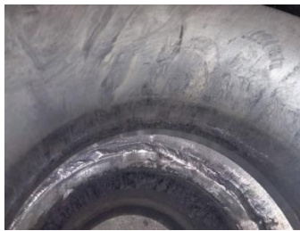
Рис. 9. Матриця після протягування для радіуса заокруглення R/d = 3,0
