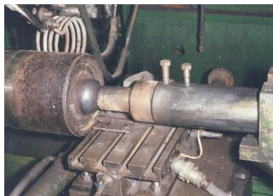
Рис. 3. Індукційне нагрівання та обкочування трубної заготовки перед обкочуванням
