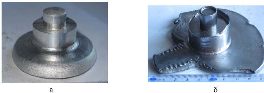
Рис. 9. Деталі типу «стрижень з фланцем і відростком» (а) і характер руйнування деталей, які отримані комбінованим видавлюванням (б)
