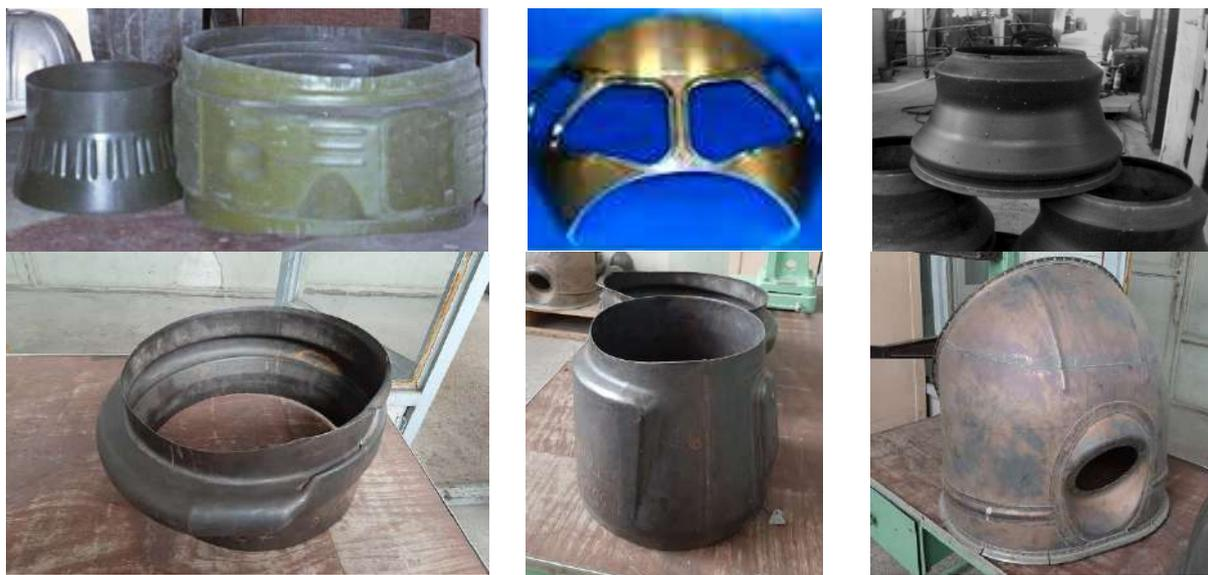
Рис. 4. Оболочковые детали, изготовленные штамповкой взрывом
