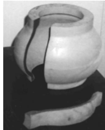
Рис. 8. Шаровая опора автомобиля КрАЗ: наружный диаметр 400 мм; толщины стенки детали 8 мм
